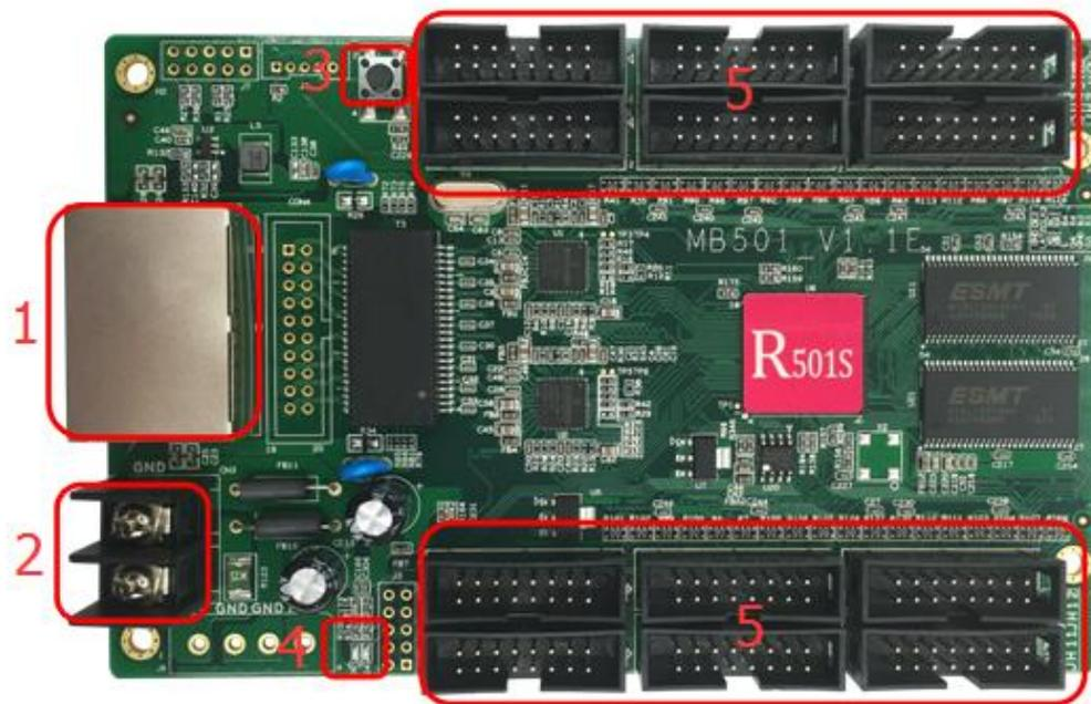
①：电源接口，可接 4V~6V 电压；
